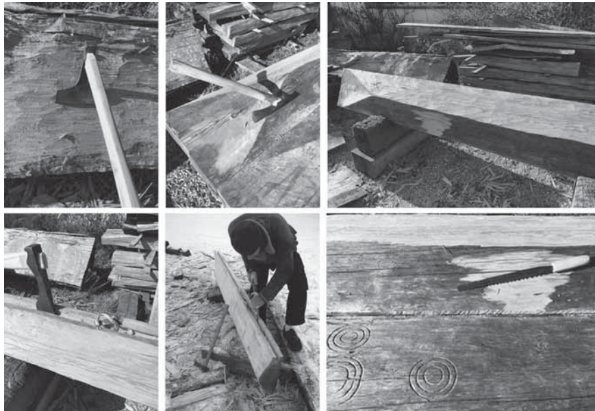
Figur 16. Rekonstruktion av tillverkningsprocessen. Arbete med den stora tväryxan, rekonstruktionen av SHM 21 592:63, ger ett spår som liknar spåren som återfinns på Hemsematerialets syllar, väggband och väggstavar (jämför med bild 10 c och 12 a). Nederst, upphuggning och urgröpning av väggstavens notspår (d och e) med rekonstruktionen av huggyxan 21 592:61 och dragjärnet SHM 21 592:55. Nedst till höger, sammansågning av fogen mellan två väggstavar med rekonstruktionen av sågen SHM 21 592:41. Fotograf: Magnus Sjöholm.
