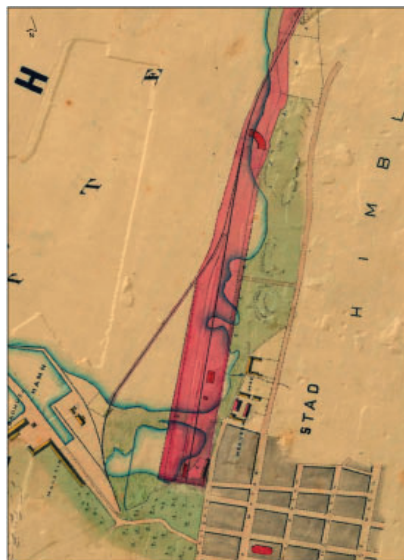
Figur 2. Karta över den planerade järnvägssträckan Varberg-Borås 1880. Varbergs kustlinje är långt ifrån rak utan består av många vikar som måste fyllas ut. Dagens terräng ligger under kartan. Källa: Lantmäteriet. Bearbetning förf.
